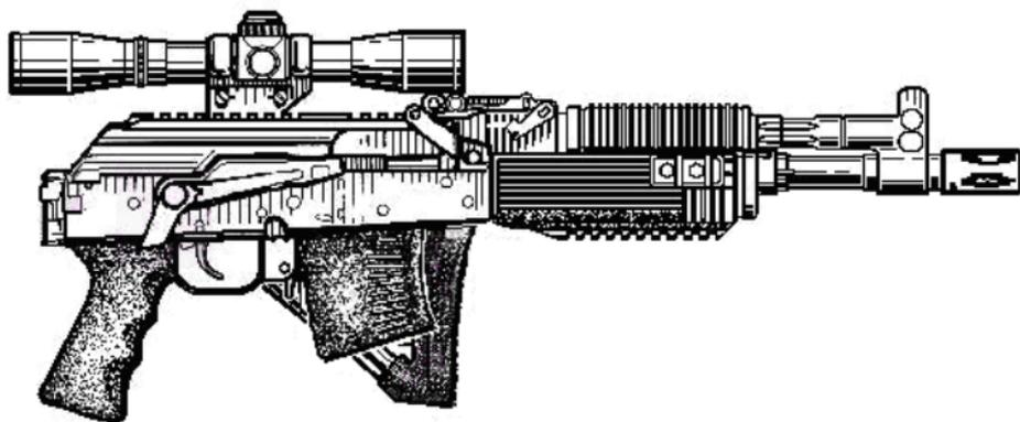
Рисунок 3 - Карабин охотничий самозарядный модели «Вепрь-1В» калибра 7,62x54R, (ВПО-129-01) со сложенным прикладом
