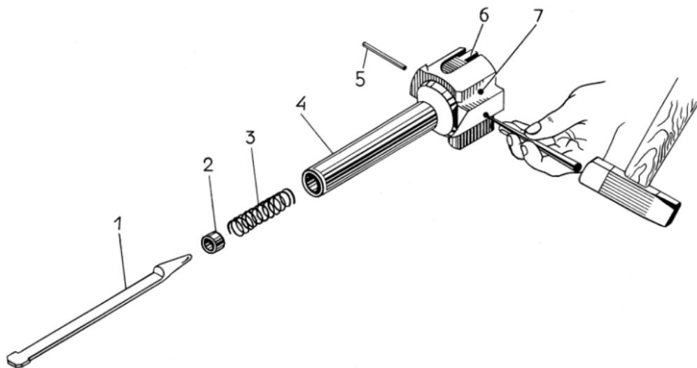
1-ударник; 2-втулка; 3-пружина ударника; 4-затвор; 5-штифт ударника; 6-выбрасыватель с пружиной; 7-ось выбрасывателя
