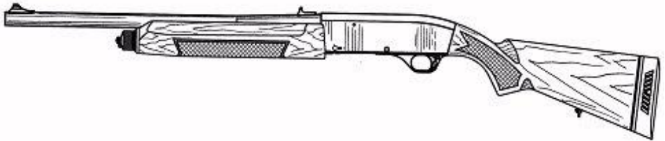
Рисунок 2- Ружье охотничье самозарядное модели «Бекас - авто» калибра 12/76 с коротким стволом
